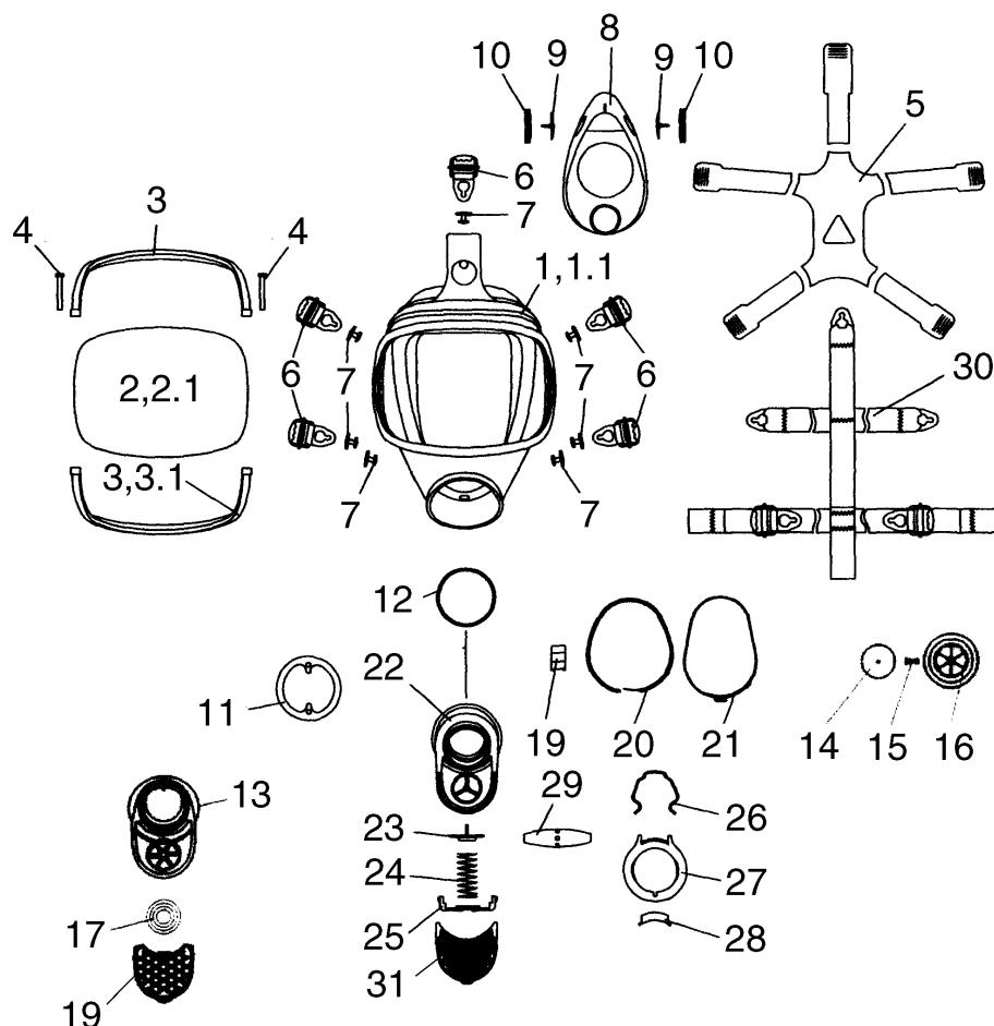
Ausatemventil fuer P und PE/exhalation valve for P and PE
